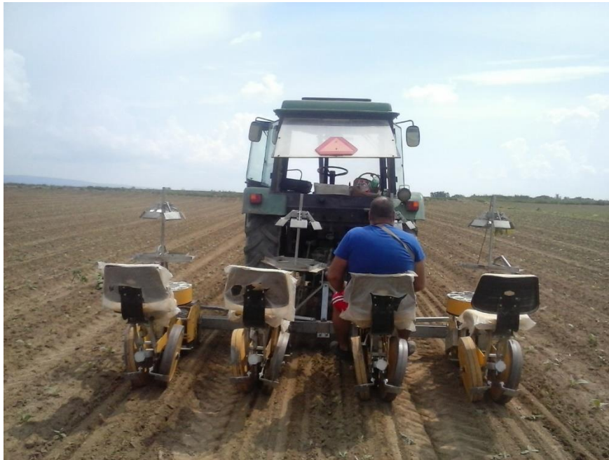
Slika 5. Utjecaj vibracija na trup rukovatelja sadilicom duhana (vlastita fotografija)
