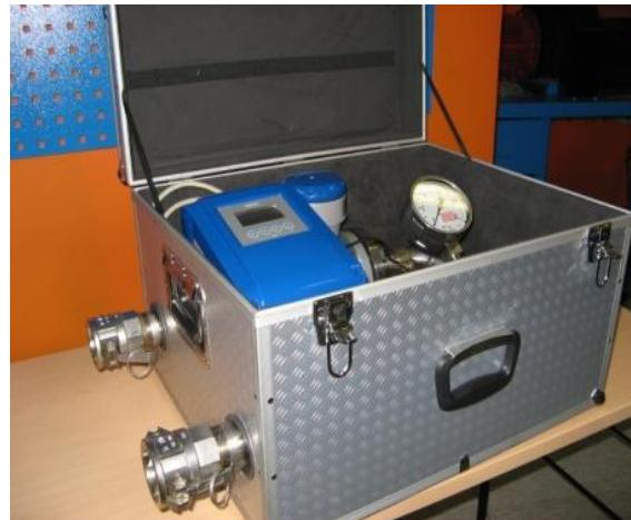
Slika 6. Elektromagnetski mjerač kapaciteta crpke tvrtke *Krohne*
