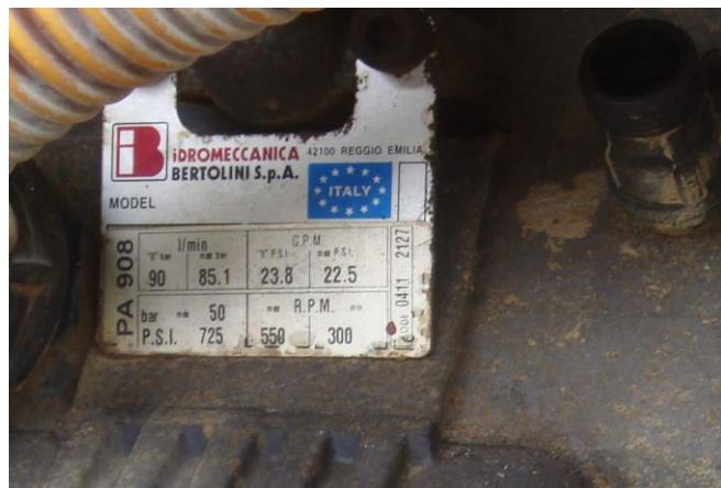
Slika 3. Pločica proizvođača na klipno-membranskoj crpki
