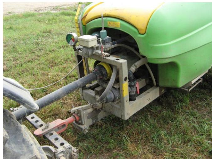
Slika 1. Pravilno postavljena zaštita priključnog vratila
