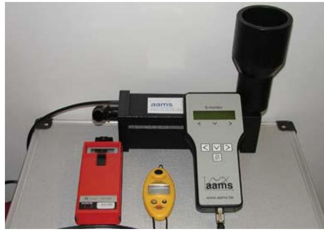
Slika 9. Uređaj AAMS za mjerjenje protoka mlaznica
