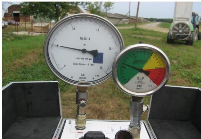
Slika 4. Ispitivanje ispravnosti rada manometara
