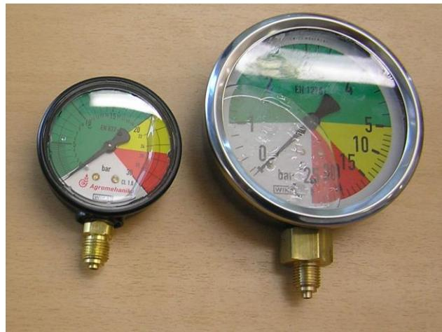
Slika 5. Uređaji za kontrolu tlaka promjera 63 i 100 mm
