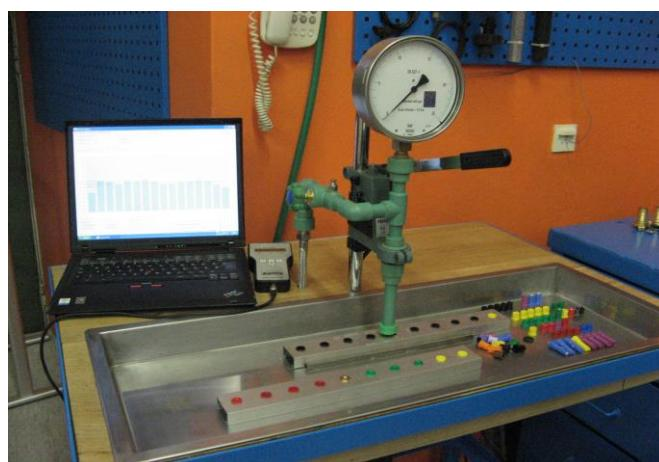
Slika 8. Stolno – elektronski uređaj za mjerjenje protoka mlaznica
