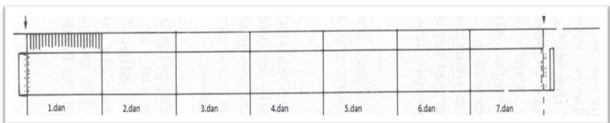
Slika 3 Način rezanja trake skinute sa bubnja
