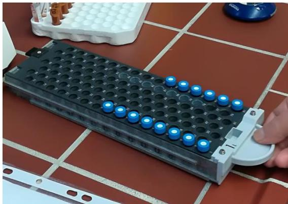
**Slika 4: Viali s pripremljenim standardima, kontrolama i uzorcima složeni u nosač**
