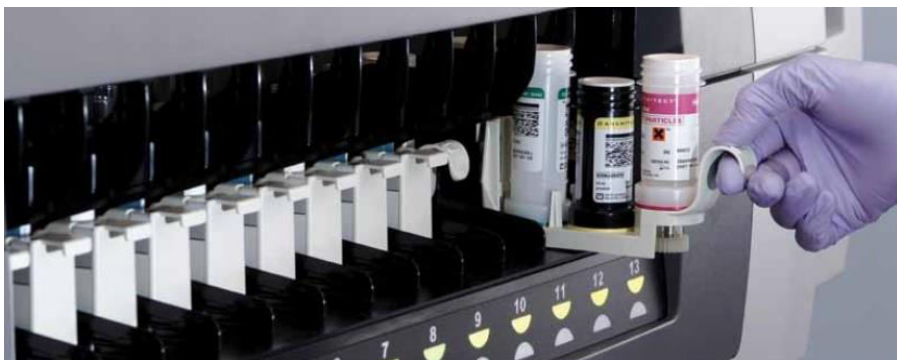
Slika 8: Ulaganje reagensa u uredaj Arcihtect i1000SR
