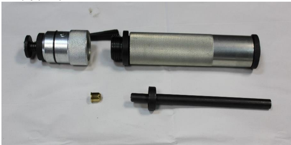
Slika 1 – Pištolj za omamljivanje stoke
