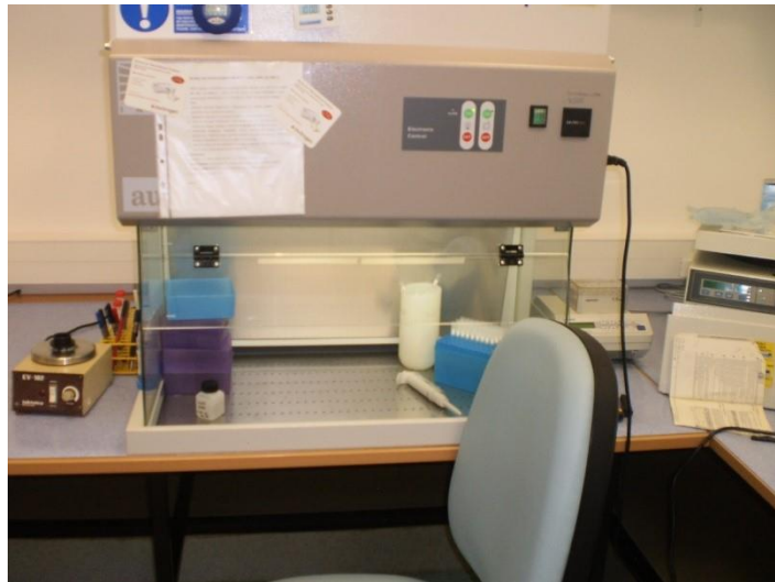
Slika 2. Biokabinet za sterilni rad, laboratorij za molekularnu dijagnostiku mikroorganizama
