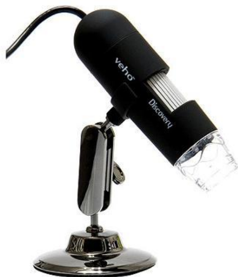
Slika 4. Prikaz USB kamere Veho Discovery VMS-004 Deluxe
