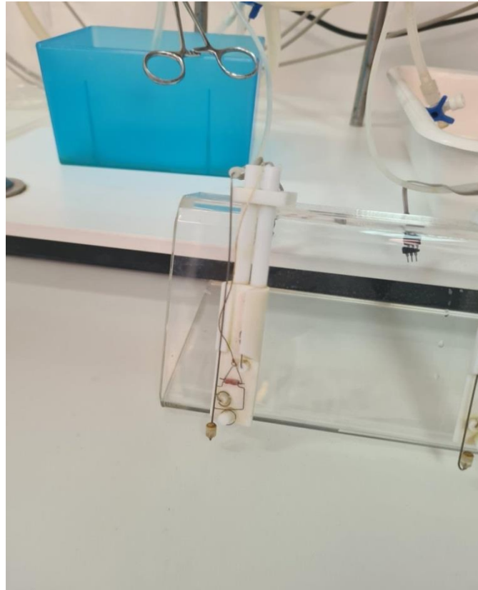
Slika 5. Aortni prsten smješten na nosač (izvor: original autora rada)
