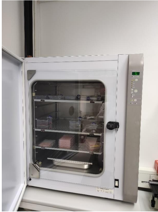
Slika 1. CO 2 inkubator za uzgoj staničnih kultura u optimalnim uvjetima . Izvor: Osobna galerija autora završnog rada
