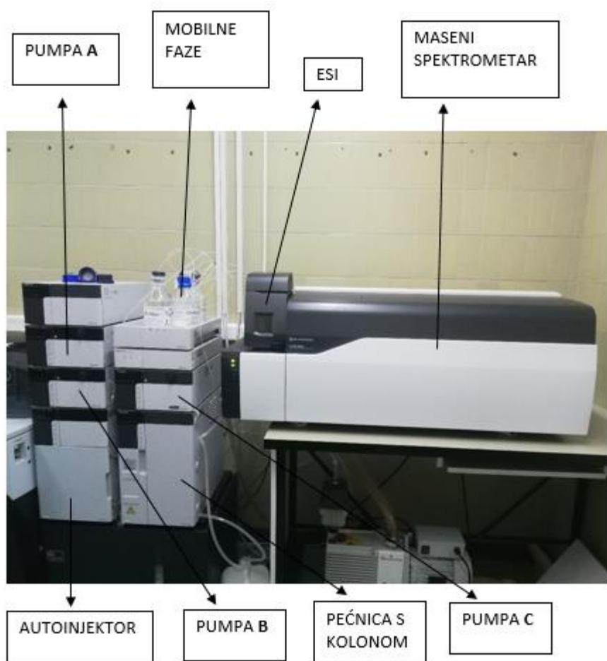
Slika 3. HPLC spregnut s LCMS 8050 spektrometrom masa
