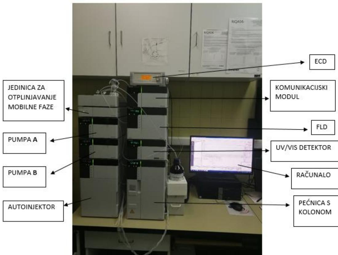
Slika 2. HPLC uređaj s elektrokemijskim detektorom (ECD)
