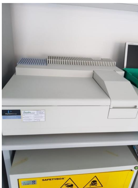
Slika 3. Perkin Elmer Lambda 25 UV/VIS spektrometar kojim je mjerena apsorbancija u uzorcima na 405 nanometara
