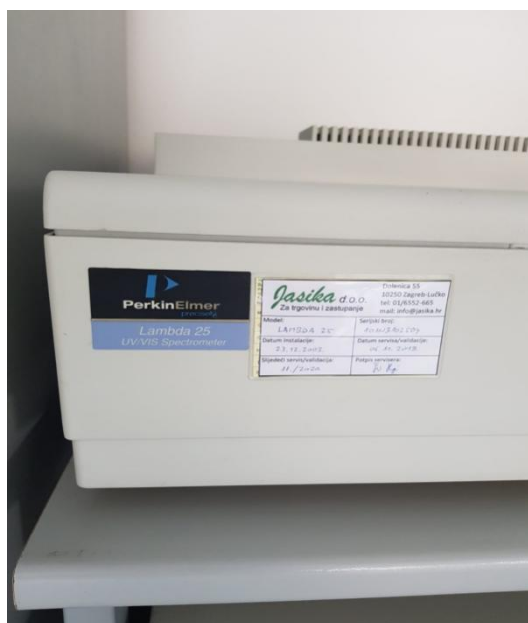
Slika 3. Perkin Elmer Lambda 25 UV/VIS spektrometar kojim je mjerena apsorbancija u uzorcima na 405 nanometara
