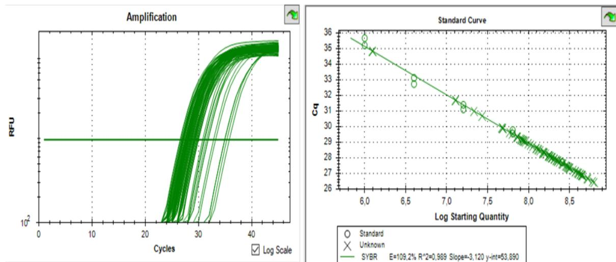
**Slika 2.** Reprezentativni ispis rezultata izražaja gena te pripadajuće standardne krivulje (izvor: originalni ispis s uređaja Bio Rad CFX93 koji se nalazi u sklopu laboratorijskog molekularno-kliničkog imunologa)
