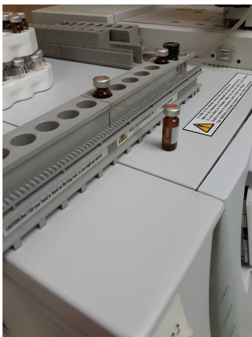
Slika 9: Postavljanje uzorka na GC-MS (fotografija autorice)
