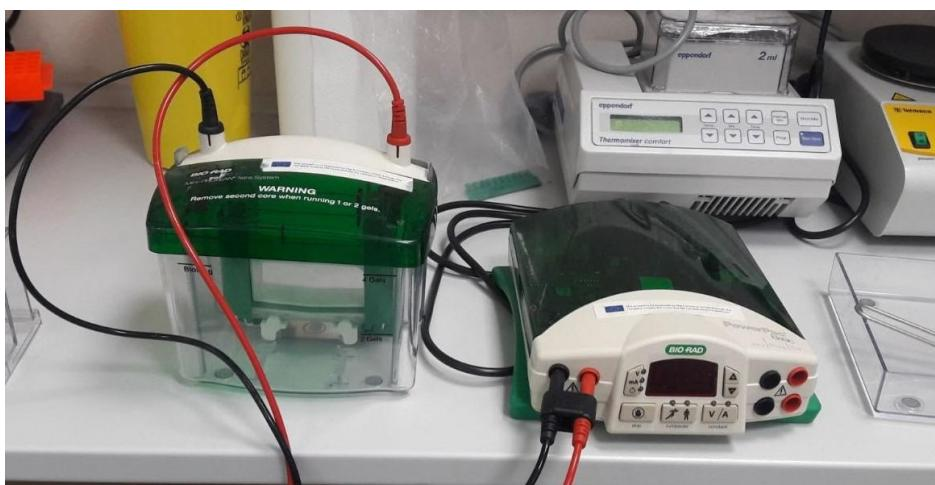
**Slika 2.** Postavljen sustav za provođenje elektroforeze (izvor: original autorice rada)
