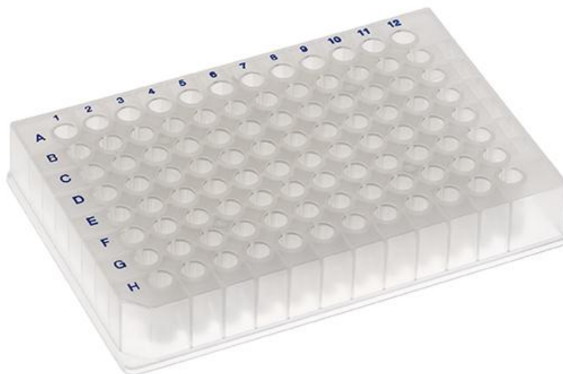
Slika 2. Mikrotitarska pločica za mjerenje koncentracije proteina Bradford metodom.
