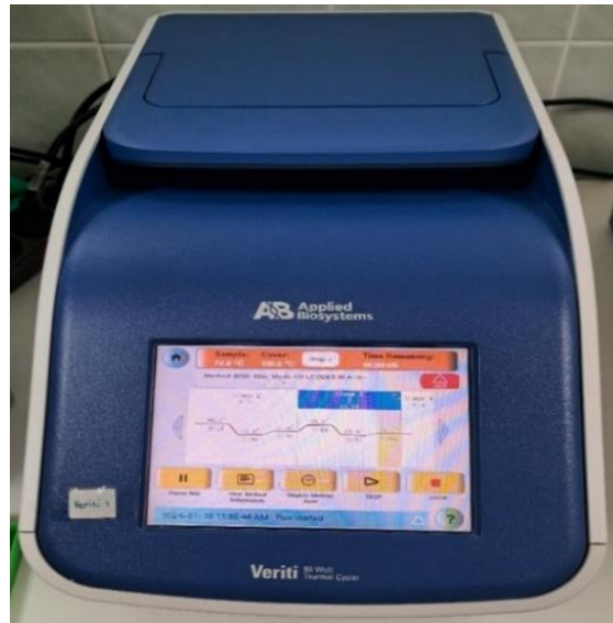
Slika 5. Uređaj Veriti™ 96-Well Thermal Cycler, fotografiju snimila autorica u Laboratoriju za molekularnu i HLA dijagnostiku, KBC Osijek, ožujak 2024.
