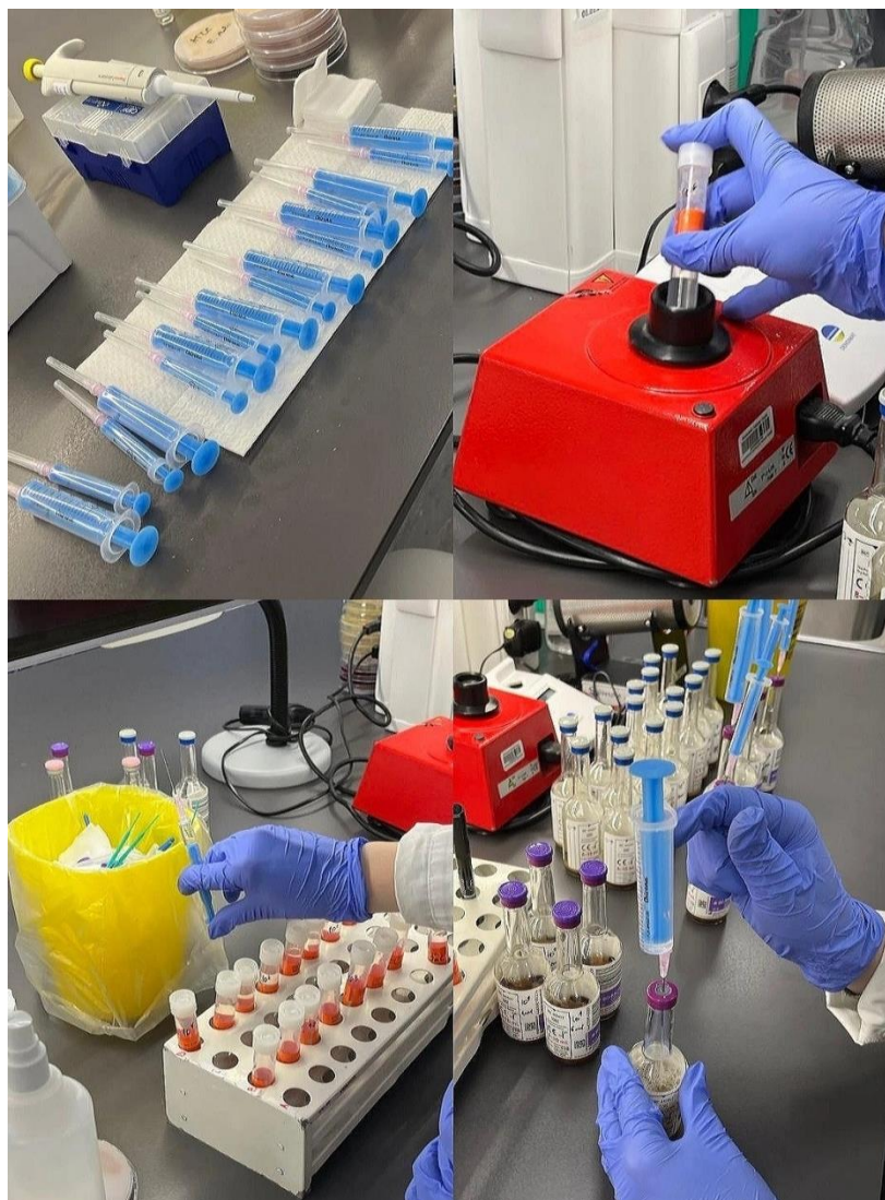
Slika 5: Pripremiti sterilne igle i šprice od 1 mL i 10 mL kojima inokuliramo 1 mL, odnosno 6 mL bakterijske suspenzije u sterilne bočice za hemokulturu. Prije inokulacije potrebno je suspenzije opet dobro promiješati na vorteksu kako bi se postigla bolja homogenizacija. Nakon što je u špricu uzet odgovarajući volumen suspenzije bakterija, potrebno je pažljivo izbaciti mjehuriće zraka te se tada može inokulirati u bočicu za hemokulturu. Izvor: Autorica rada
