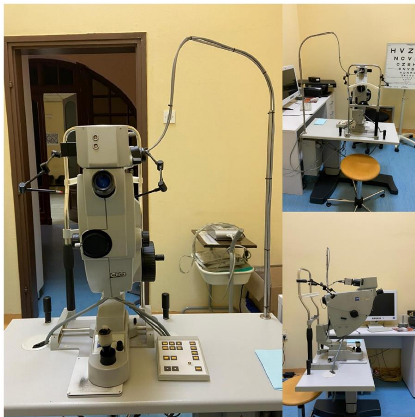
Slika 3. Uređaj SOCT Copernicus za optičku koherentnu tomografiju. Fotografirala autorica.
