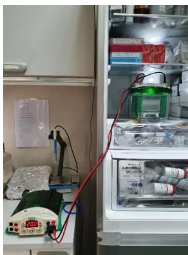
Slika 7. Sustav za SDS – PAGE elektroforezu na 4°C (izvor: original autorice rada)
