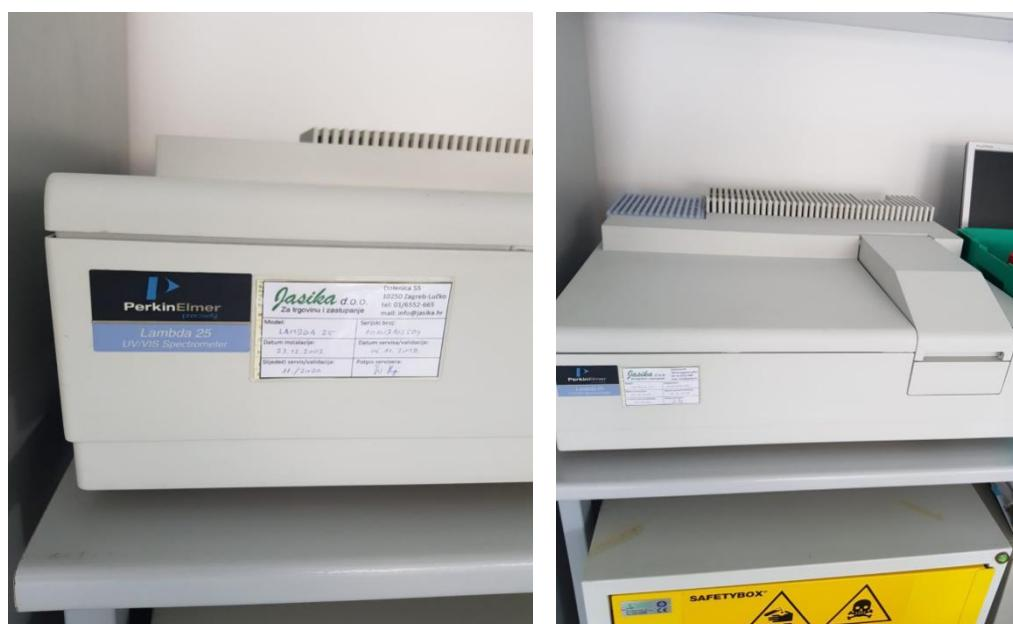
**Slika 3.** Perkin Elmer Lambda 25 UV/VIS sprektrometar kojim je mjerena apsorbancija u uzorcima na 405 nanometara
