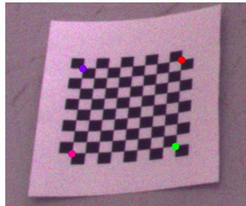
(b) Slika uzorka na sceni koji nije u ptičjoj perspektivi. Susjedni vrhovi uzorka nisu jednakо udaljeni.
