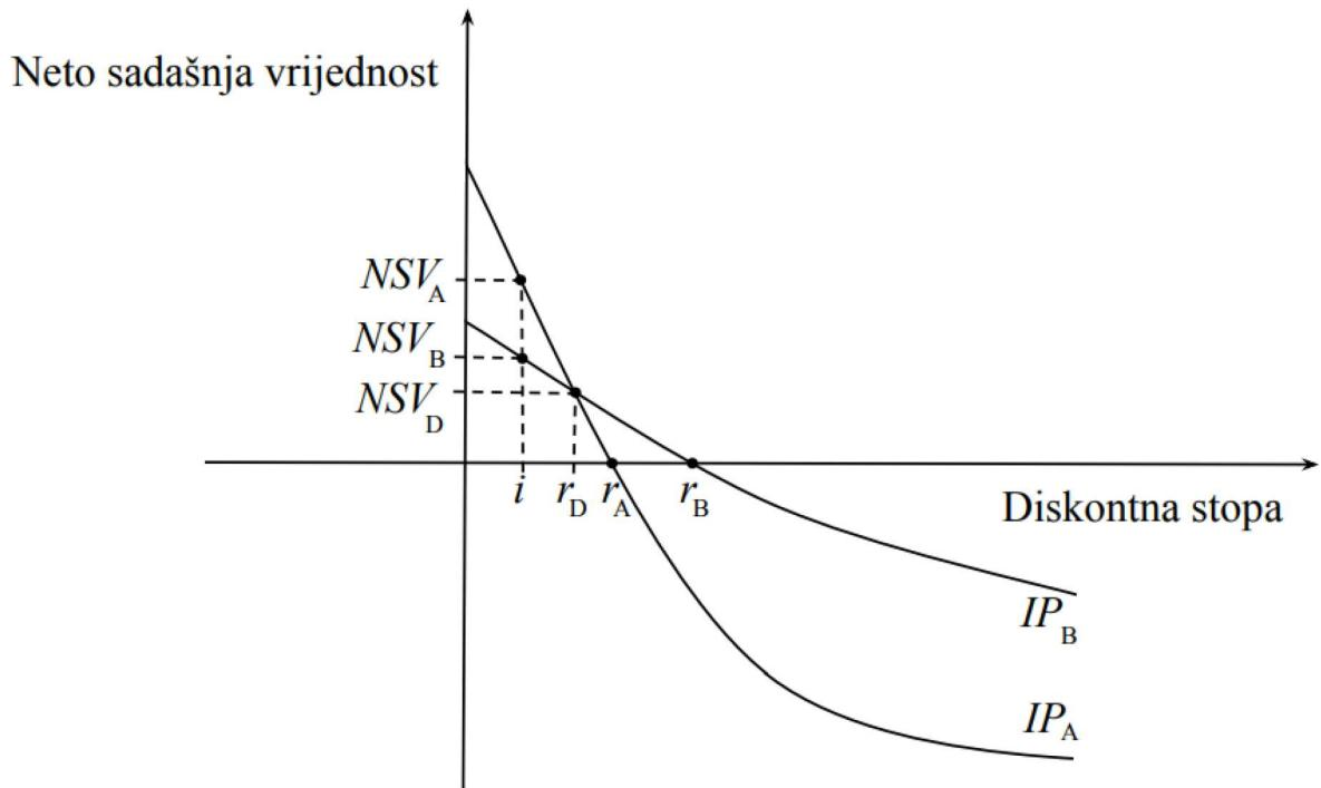
Slika 3: NSV diferencijalnog ulaganja kao funkcija diskontne stope
