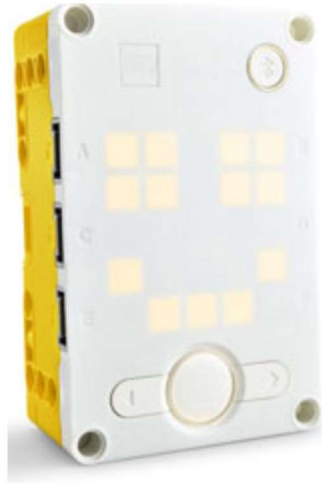
Slika 8: SPIKE Prime hub (slika preuzeta iz [12]).
