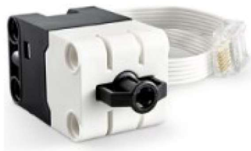
Slika 9: SPIKE Prime senzor sile (slika preuzeta iz [12]).
