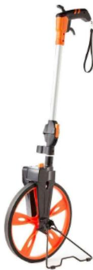
Slika 28: Mjerni kotač
