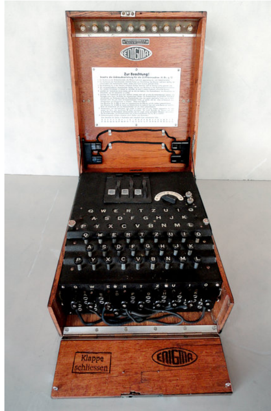
Slika 3: Standardni model Enigme
