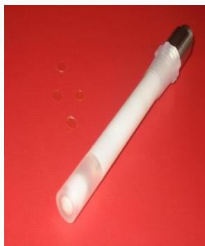
*Slika 27. Phillips-ova indikatorska elektroda [12]*
