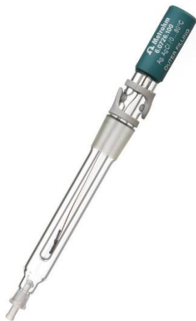
Slika 6: Elektroda srebro/srebrov klorid
