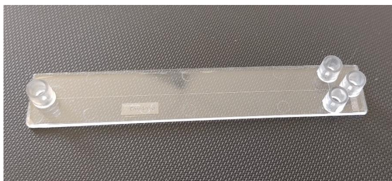
Slika 12. Mikročip korišten u elektroforetskim mjerenjima.
