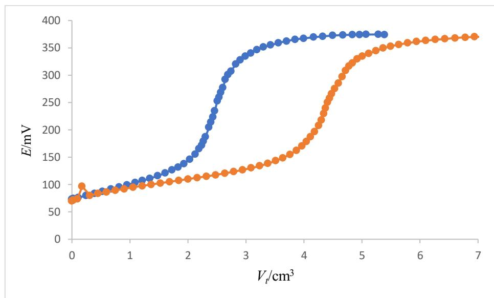
Slika 9. Titracijske krivulje dobivene pri potenciometrijskoj titraciji otopine tekućeg deterdženta za pranje odjeće otopinom CPC-a ( $c = 4 \times 10^{-3} \text{ mol}/\text{dm}^3$ ) i uz poznati dodatak NaDDS-a (● deterdžent, ● deterdžent +  $2 \text{ cm}^3$  NaDDS)
