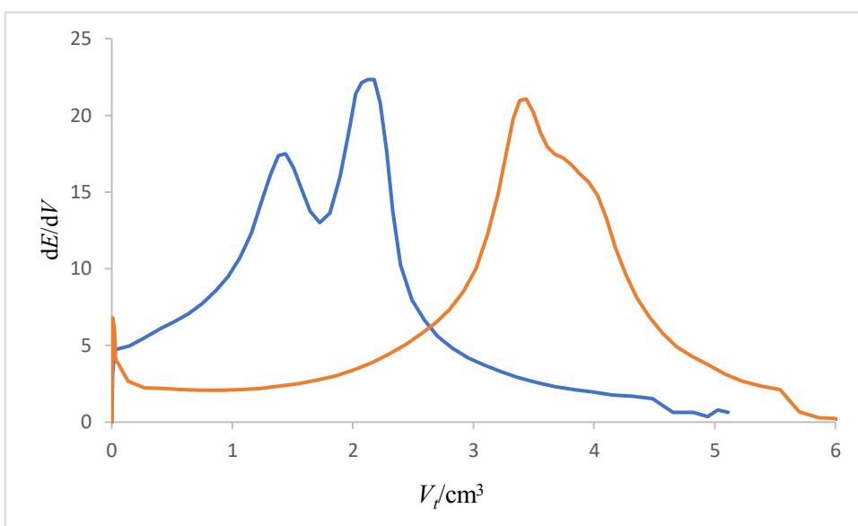
Slika 8. Derivacijske krivulje dobivene pri potenciometrijskoj titraciji otopine tekućeg deterdženta za ručno pranje posuđa otopinom CPC-a ( $c = 4 \times 10^{-3} \text{ mol}/\text{dm}^3$ ) i uz poznati dodatak NaDDS-a (— detergent, — detergent + 2 cm<sup>3</sup> NaDDS)
