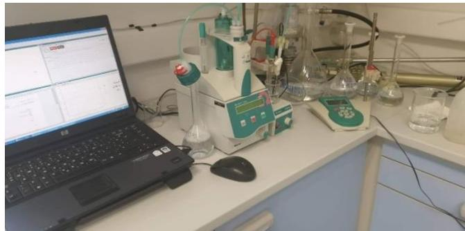
*Slika 5. 794 Basic Titrino, aparatura za titraciju*
