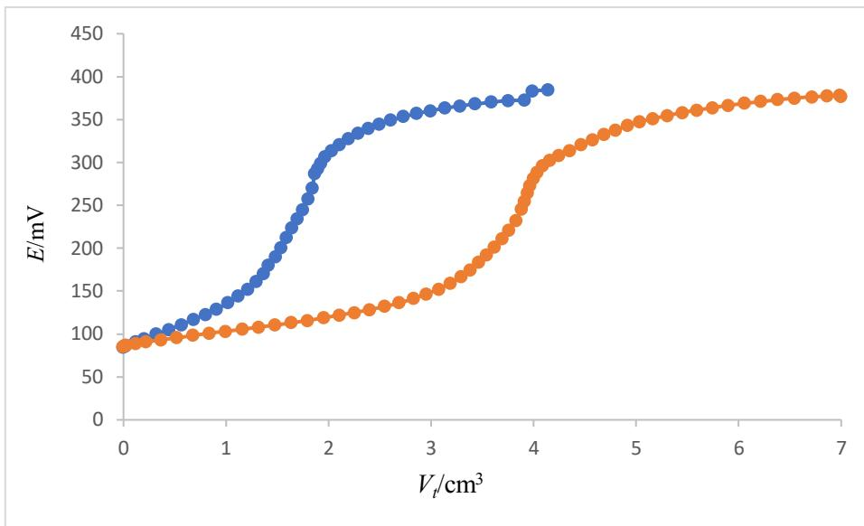
Slika 11. Titracijske krivulje dobivene pri potenciometrijskoj titraciji otopine univerzalnog tekućeg sredstva za čišćenje otopinom CPC-a ( $c = 4 \times 10^{-3} \text{ mol}/\text{dm}^3$ ) i uz poznati dodatak NaDDS-a (● sredstvo za čišćenje, ● sredstvo za čišćenje + 2  $\text{cm}^3$  NaDDS)
