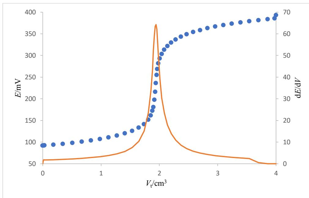
Slika. 6. Titracijska (●) i derivacijska krivulja (—) dobivene pri potenciometrijskoj titraciji otopine NaDDS-a ( $c = 4 \times 10^{-3}$  mol/dm<sup>3</sup>) otopinom CPC-a ( $c = 4 \times 10^{-3}$  mol/dm<sup>3</sup>)
