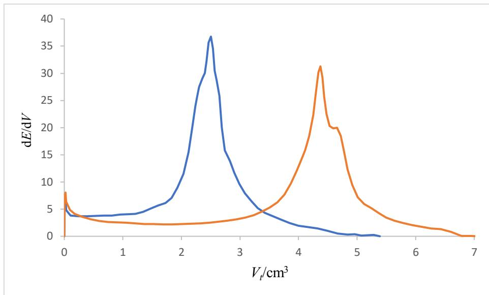
Slika 10. Derivacijske krivulje dobivene pri potenciometrijskoj titraciji otopine tekućeg deterdženta za pranje odjeće otopinom CPC-a ( $c = 4 \times 10^{-3} \text{ mol/dm}^3$ ) i uz poznati dodatak NaDDS-a (— deterdžent, — deterdžent +  $2 \text{ cm}^3$  NaDDS)
