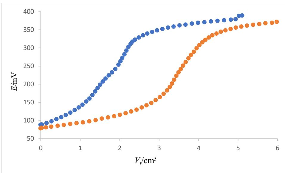
Slika 7. Titracijske krivulje dobivene pri potenciometrijskoj titraciji otopine tekućeg deterdženta za ručno pranje posuđa otopinom CPC-a ( $c = 4 \times 10^{-3} \text{ mol}/\text{dm}^3$ ) i uz poznati dodatak NaDDS-a (● deterdžent, ● deterdžent + 2 cm<sup>3</sup> NaDDS)
