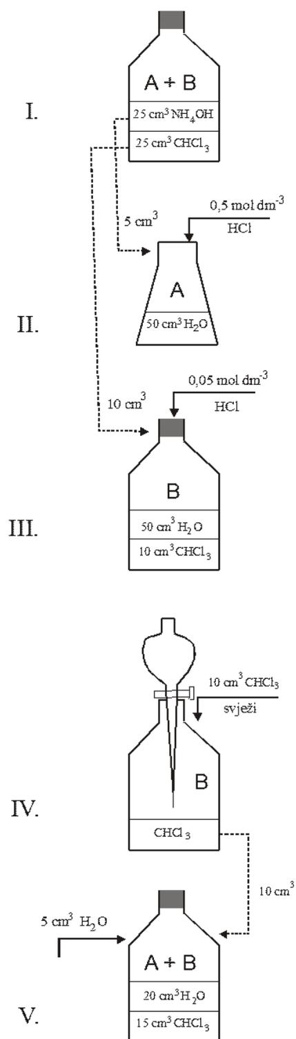
Slika 5. Shema izvedbe eksperimenta. <sup>(17)</sup>
