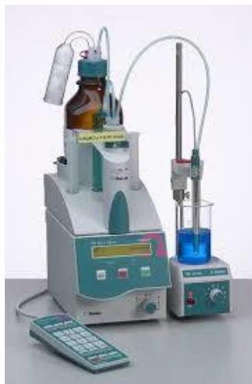
*Slika 8. Automatski titrator 794 Basic Titrino [20]*
