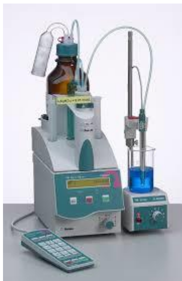
Slika 8. Automatski titrator 794 Basic Titrino [20]
