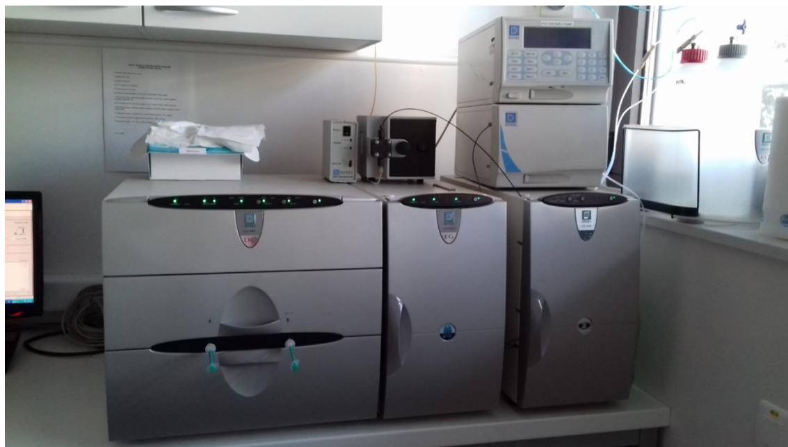
Slika 16. Ionski kromatograf, ICS 3000 Dionex.
