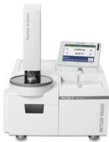
Slika 11. TGA-DSC analizator Mettler Toledo
