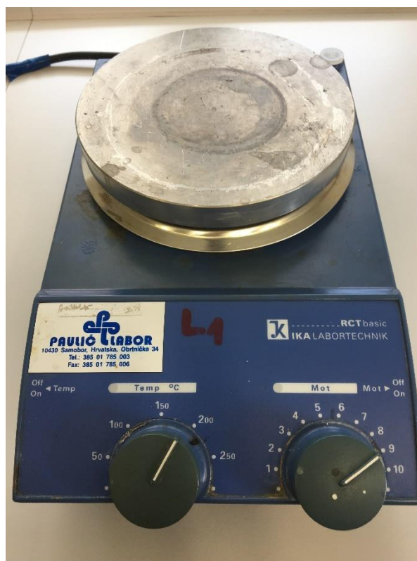
Slika8. Magnetska miješalica s grijanjem ( IKA, Njemačka)
