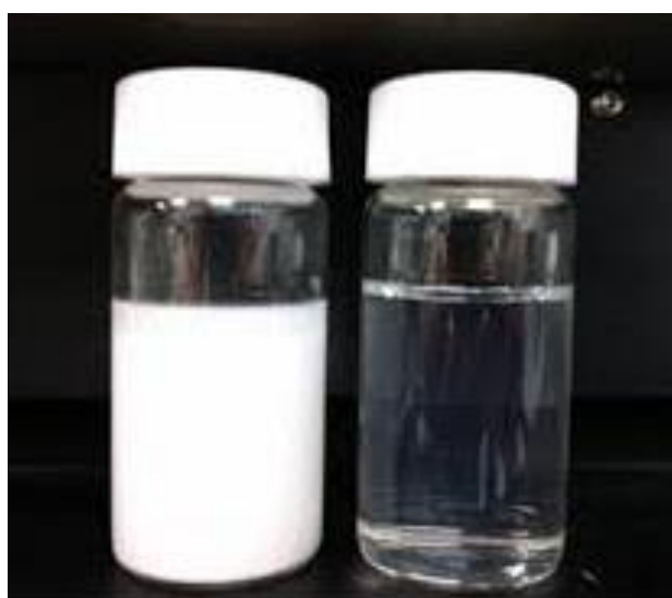
Slika 43. Bistri supernatant nakon centrifugiranja
