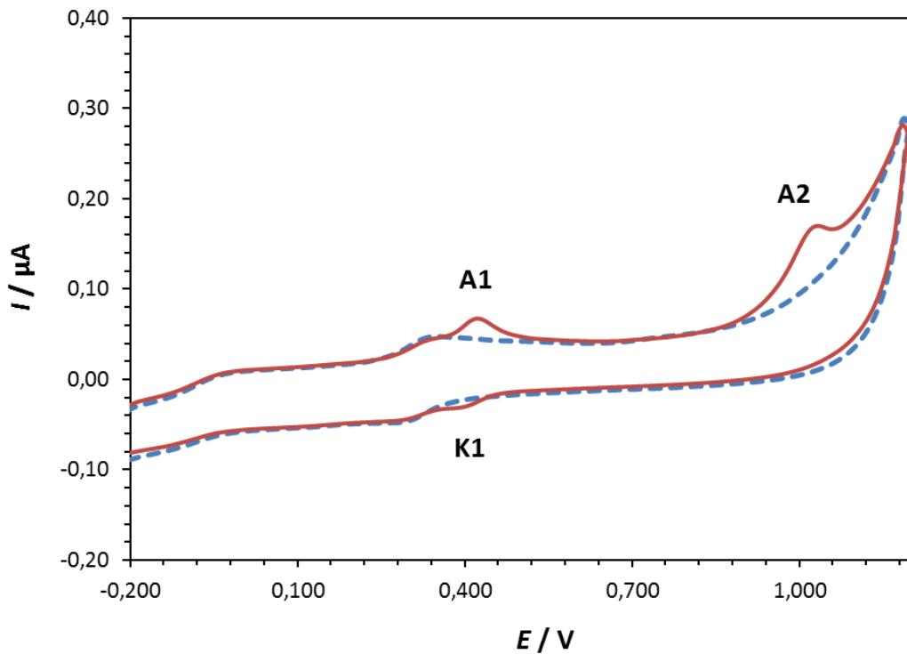
**Slika 17.** Ciklički voltamogram rutina ( $c = 1 \cdot 10^{-5}$  mol dm $^{-3}$ ) snimljen na elektrodi od staklastog ugljika u acetatnom puferu (pH = 4,5;  $I_c = 0,1$  mol dm $^{-3}$ ). Brzina polarizacije elektrode je 50 mV/s. (—) pufer, (—) otopina sa rutinom.
