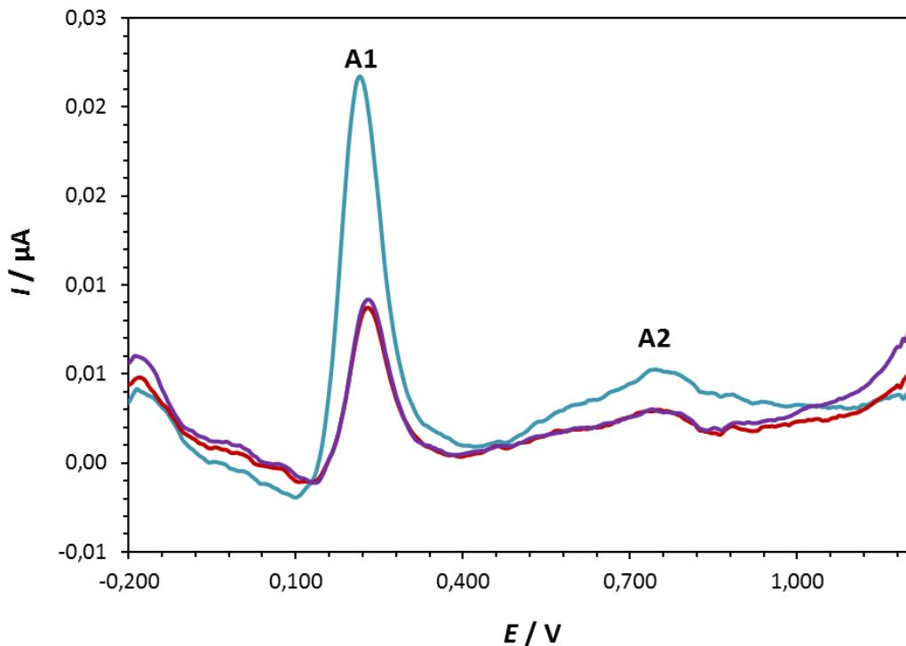
**Slika 30.** Diferencijalni pulsni voltamogram rutina ( $c = 1 \cdot 10^{-5} \text{ mol dm}^{-3}$ ) snimljen na elektrodi od staklastog ugljika u puferu ( $\text{pH} = 8,0$ ;  $I_c = 0,1 \text{ mol dm}^{-3}$ ). Brzina polarizacije elektrode je  $5 \text{ mV/s}$ . (—) 1. scan, (—) 2. scan, (—) 3. scan.
