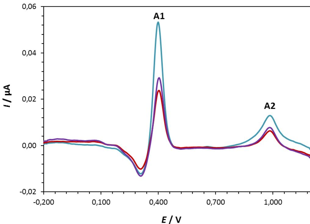
**Slika 27.** Diferencijalni pulsni voltamogram rutina ( $c = 1 \cdot 10^{-5} \text{ mol dm}^{-3}$ ) snimljen na elektrodi od staklastog ugljika u puferu ( $\text{pH} = 4,5$ ;  $I_c = 0,1 \text{ mol dm}^{-3}$ ). Brzina polarizacije elektrode je  $5 \text{ mV/s}$ . (—) 1. scan, (—) 2. scan, (—) 3. scan.
