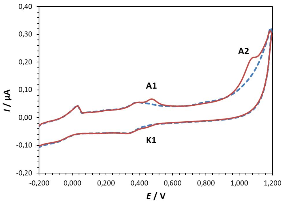
**Slika 15.** Ciklički voltamogram rutina ( $c = 1 \cdot 10^{-5}$  mol dm $^{-3}$ ) snimljen na elektrodi od staklastog ugljika u acetatnom puferu (pH = 3,5;  $I_c = 0,1$  mol dm $^{-3}$ ). Brzina polarizacije elektrode je 50 mV/s. (---) pufer, (—) otopina sa rutinom.
