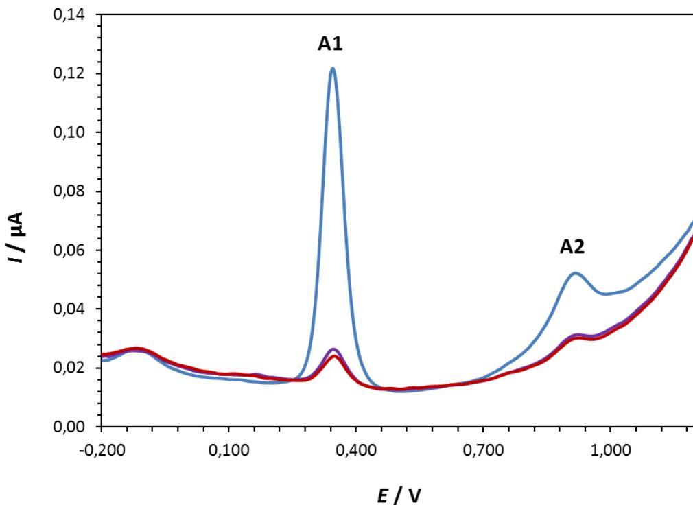
**Slika 28.** Diferencijalni pulsni voltamogram rutina ( $c = 1 \cdot 10^{-5} \text{ mol dm}^{-3}$ ) snimljen na elektrodi od staklastog ugljika u puferu ( $\text{pH} = 5,5$ ;  $I_c = 0,1 \text{ mol dm}^{-3}$ ). Brzina polarizacije elektrode je  $5 \text{ mV/s}$ . (-) 1. scan, (-) 2. scan, (-) 3. scan.
