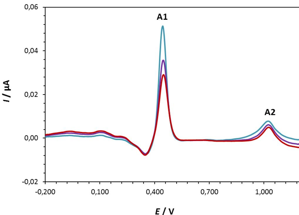
**Slika 26.** Diferencijalni pulsni voltamogram rutina ( $c = 1 \cdot 10^{-5} \text{ mol dm}^{-3}$ ) snimljen na elektrodi od staklastog ugljika u puferu ( $\text{pH} = 3,5$ ;  $I_c = 0,1 \text{ mol dm}^{-3}$ ). Brzina polarizacije elektrode je  $5 \text{ mV/s}$ . (—) 1. scan, (—) 2. scan, (—) 3. scan.
