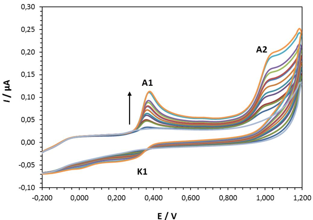
**Slika 25.** Ciklički voltamogrami različitih koncentracija otopine rutina, snimljeni na elektrodi od staklastog ugljika u acetatnom puferu (pH = 5,5;  $I_c = 0,1$  mol dm $^{-3}$ ).
