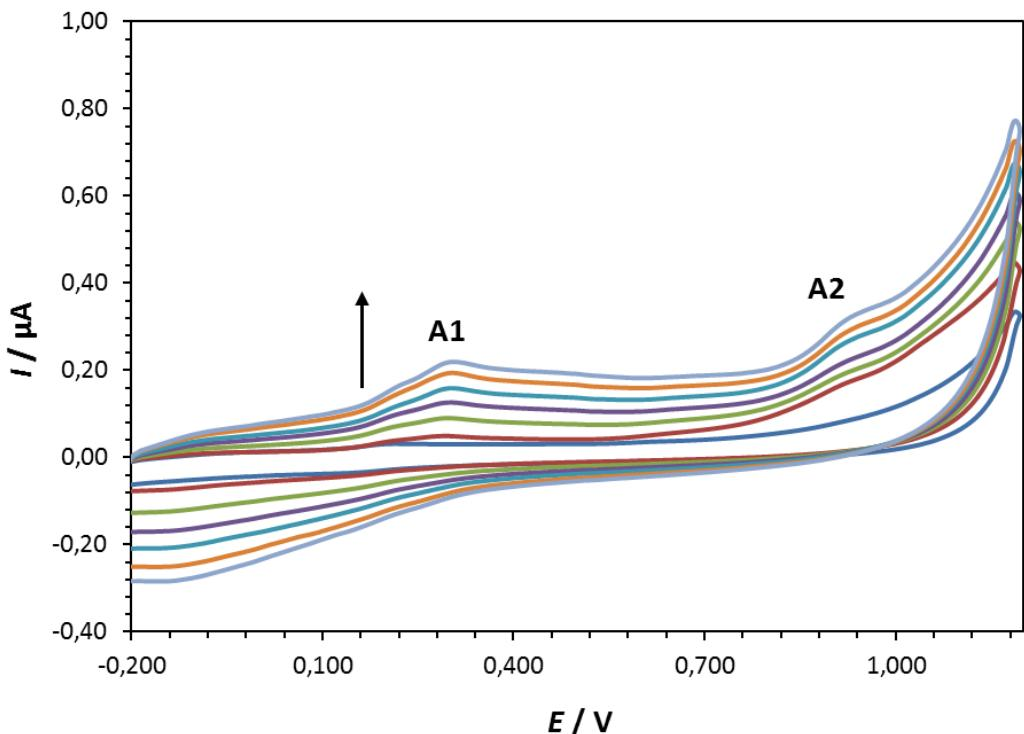
**Slika 22.** Ciklički voltamogram rutina ( $c = 1 \cdot 10^{-5} \text{ mol dm}^{-3}$ ) snimljen na elektrodi od staklastog ugljika u acetatnom puferu (pH = 7,0;  $I_c = 0,1 \text{ mol dm}^{-3}$ ) pri različitim brzinama polarizacije elektrode. (—) pufer, (—) otopina s rutinom; brzina polarizacije elektrode 50 mV/s, (—) 100 mV/s, (—) 150 mV/s, (—) 200 mV/s, (—) 250 mV/s, (—) 300 mV/s.
