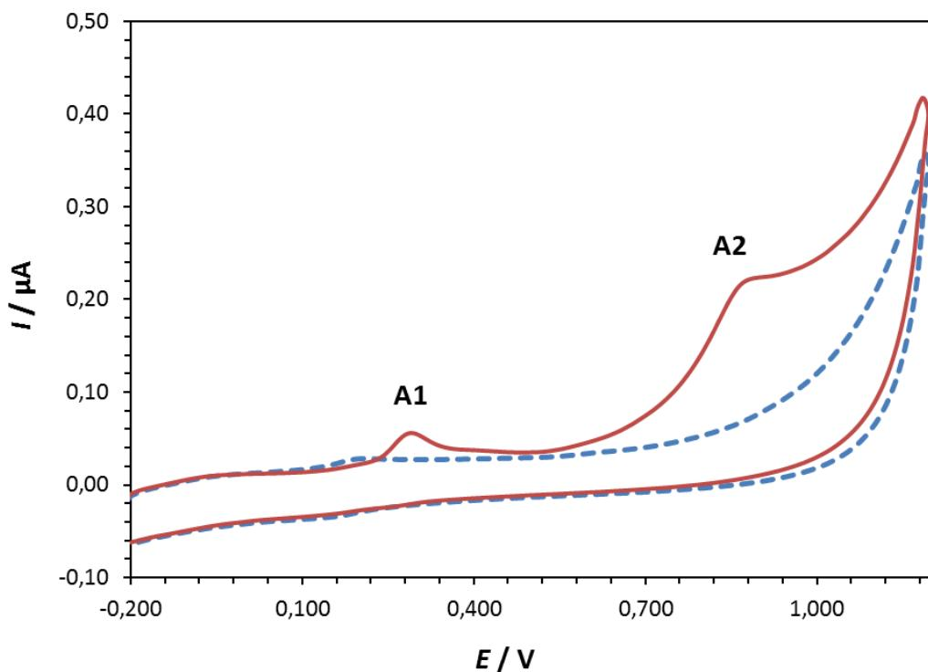
**Slika 21.** Ciklički voltamogram rutina ( $c = 1 \cdot 10^{-5}$  mol dm $^{-3}$ ) snimljen na elektrodi od staklastog ugljika u puferu (pH = 7,0;  $I_c = 0,1$  mol dm $^{-3}$ ). Brzina polarizacije elektrode je 50 mV/s. (---) pufer, (—) otopina sa rutinom.
