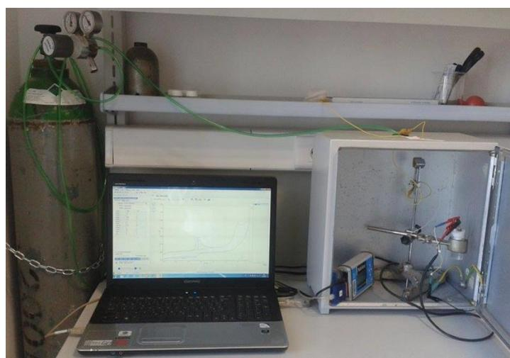
**Slika 11.** Aparatura za voltametrijska mjerena (PalmSens potenciostat/galvanostat).
