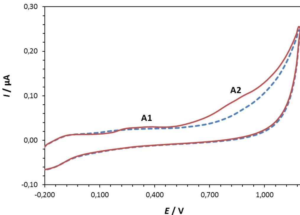
**Slika 23.** Ciklički voltamogram rutina ( $c = 1 \cdot 10^{-5}$  mol dm $^{-3}$ ) snimljen na elektrodi od staklastog ugljika u puferu (pH = 8,0;  $I_c = 0,1$  mol dm $^{-3}$ ). Brzina polarizacije elektrode je 50 mV/s. (---) pufer, (—) otopina sa rutinom.
