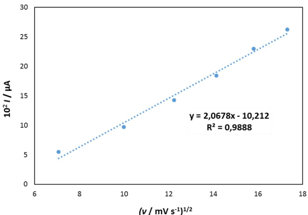
**Slika 32.** Ovisnost vrijednosti struje prvog oksidacijskog strujnog vrha ( $I$ ) o drugom korijenu brzine promjene potencijala ( $v^{1/2}$ ) pri pH = 5,5.
