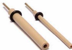
**Slika 12.** Radna elektroda od staklastog ugljika („glassy carbon“) [20].
