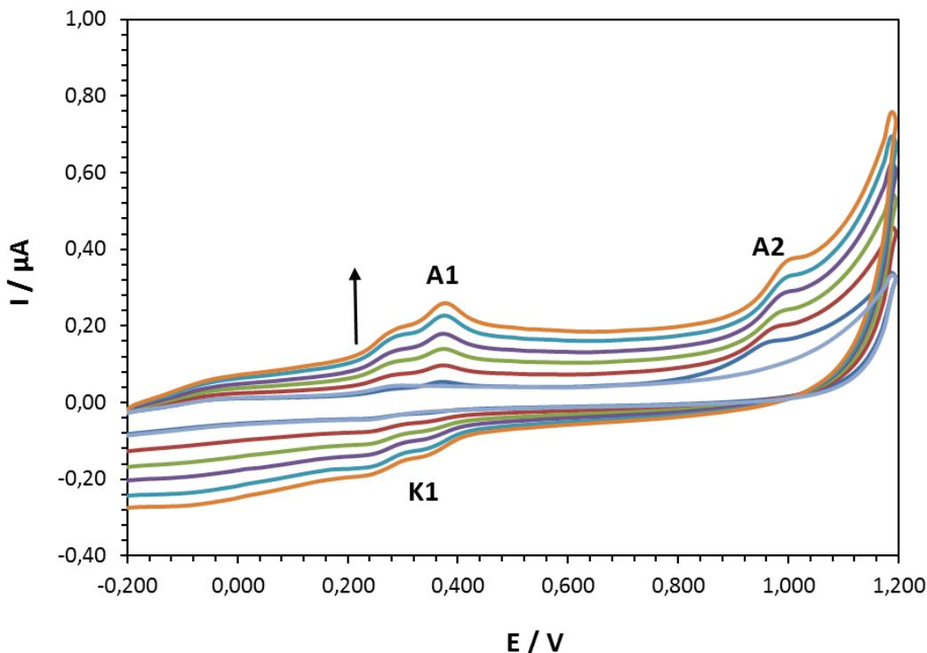
**Slika 20.** Ciklički voltamogram rutina ( $c = 1 \cdot 10^{-5} \text{ mol dm}^{-3}$ ) snimljen na elektrodi od staklastog ugljika u acetatnom puferu ( $\text{pH} = 5,5$ ;  $I_c = 0,1 \text{ mol dm}^{-3}$ ) pri različitim brzinama polarizacije elektrode. (—) pufer, (—) otopina s rutinom; brzina polarizacije elektrode: 50 mV/s, (—) 100 mV/s, (—) 150 mV/s, (—) 200 mV/s, (—) 250 mV/s, (—) 300 mV/s.
