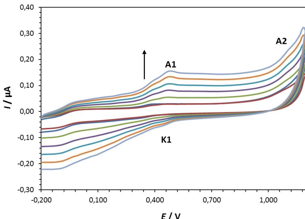
**Slika 16.** Ciklički voltamogram rutina ( $c = 1 \cdot 10^{-5}$  mol dm<sup>-3</sup>) snimljen na elektrodi od staklastog ugljika u acetatnom puferu (pH = 3,5;  $I_c = 0,1$  mol dm<sup>-3</sup>) pri različitim brzinama polarizacije elektrode. (—) pufer, (—) otopina s rutinom; brzina polarizacije elektrode: 50 mV/s, (—) 100 mV/s, (—) 150 mV/s, (—) 200 mV/s, (—) 250 mV/s, (—) 300 mV/s.
