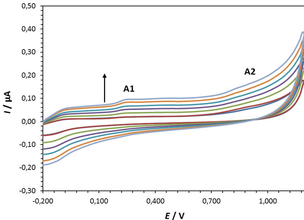
**Slika 24.** Ciklički voltamogram rutina ( $c = 1 \cdot 10^{-5} \text{ mol dm}^{-3}$ ) snimljen na elektrodi od staklastog ugljika u acetatnom puferu ( $\text{pH} = 8,0$ ;  $I_c = 0,1 \text{ mol dm}^{-3}$ ) pri različitim brzinama polarizacije elektrode. (—) pufer, (—) otopina s rutinom; brzina polarizacije elektrode: 50 mV/s, (—) 100 mV/s, (—) 150 mV/s, (—) 200 mV/s, (—) 250 mV/s, (—) 300 mV/s.
