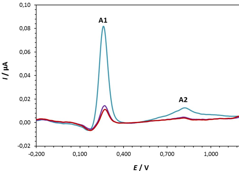
**Slika 29.** Diferencijalni pulsni voltamogram rutina ( $c = 1 \cdot 10^{-5} \text{ mol dm}^{-3}$ ) snimljen na elektrodi od staklastog ugljika u puferu ( $\text{pH} = 7,0$ ;  $I_c = 0,1 \text{ mol dm}^{-3}$ ). Brzina polarizacije elektrode je  $5 \text{ mV/s}$ . (—) 1. scan, (—) 2. scan, (—) 3. scan.
