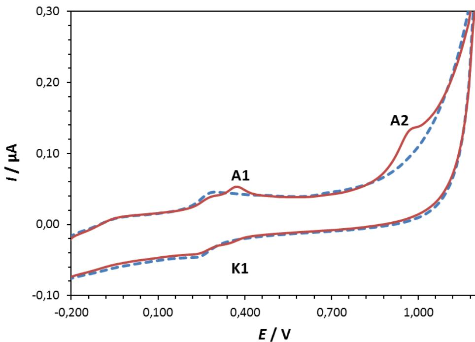
**Slika 19.** Ciklički voltamogram rutina ( $c = 1 \cdot 10^{-5}$  mol dm $^{-3}$ ) snimljen na elektrodi od staklastog ugljika u acetatnom puferu (pH = 5,5;  $I_c = 0,1$  mol dm $^{-3}$ ). Brzina polarizacije elektrode je 50 mV/s. (---) pufer, (—) otopina sa rutinom.
