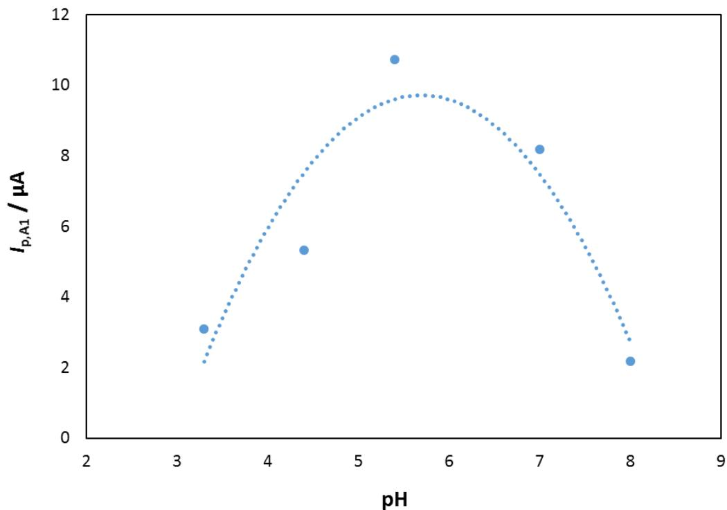
**Slika 34.** Ovisnost struje anodnog strujnog vrha o pH vrijednostima za rutin ( $c = 1 \cdot 10^{-5} \text{ mol dm}^{-3}$ ,  $I_c = 0,1 \text{ mol dm}^{-3}$ ). Brzina promjene potencijala je 5 mV/s.
