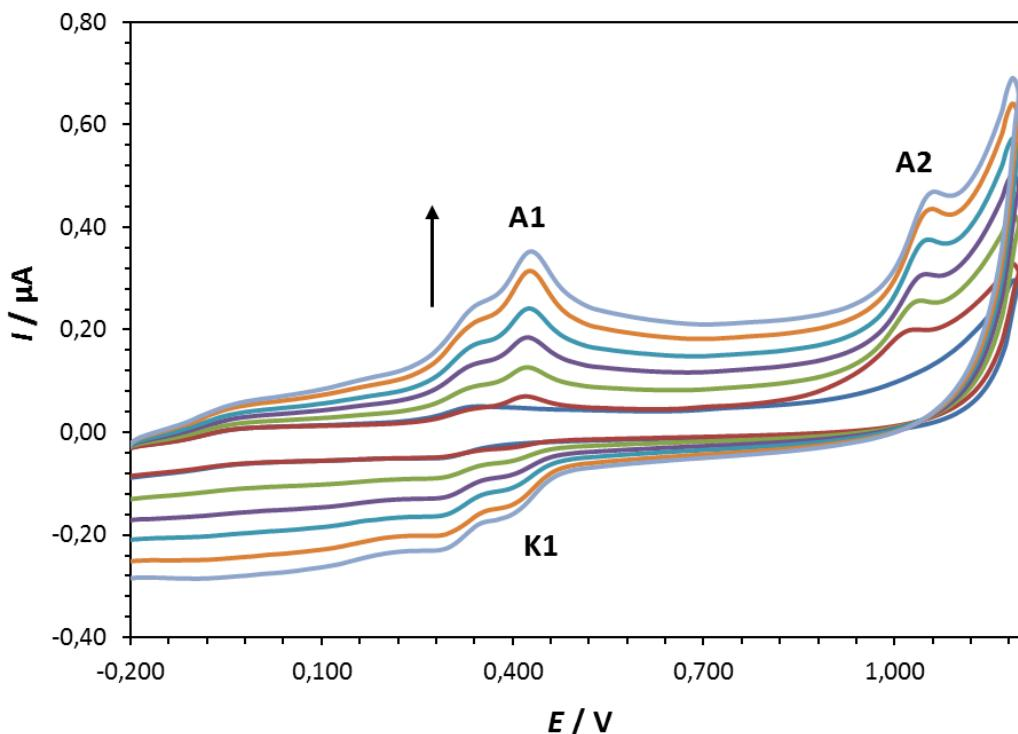
**Slika 18.** Ciklički voltamogram rutina ( $c = 1 \cdot 10^{-5} \text{ mol dm}^{-3}$ ) snimljen na elektrodi od staklastog ugljika u acetatnom puferu (pH = 4,5;  $I_c = 0,1 \text{ mol dm}^{-3}$ ) pri različitim brzinama polarizacije elektrode. (—) pufer, (—) otopina s rutinom; brzina polarizacije elektrode: 50 mV/s, (—) 100 mV/s, (—) 150 mV/s, (—) 200 mV/s, (—) 250 mV/s, (—) 300 mV/s.
