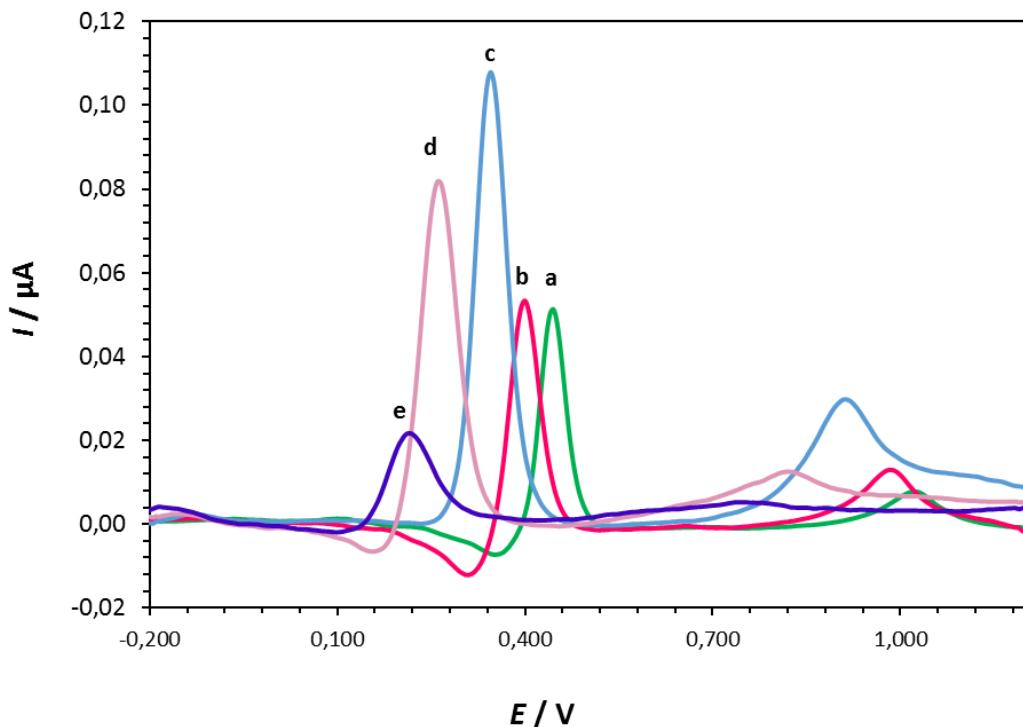
**Slika 31.** Diferencijalni pulsni voltamogrami rutina ( $c = 1 \cdot 10^{-5}$  mol dm $^{-3}$ ) snimljeni na elektrodi od staklastog ugljika kao funkcija promjene pH vrijednosti (pH = (a) 3,5; (b) 4,5; (c) 5,5; (d) 7,0; (e) 8,0). Brzina polarizacije elektrode je 5 mV/s.
