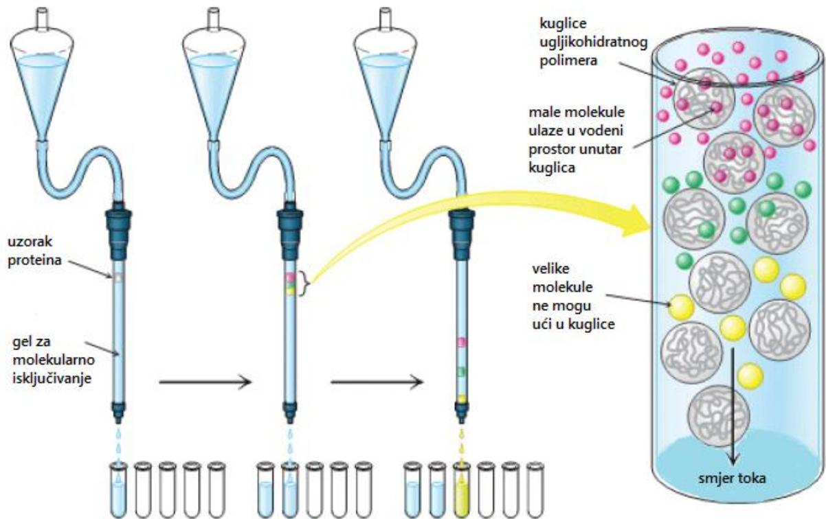
**Slika 12. Kromatografija isključivanjem ili gel-filtracijska kromatografija.** Smjesa proteina se nanosi u malom volumenu na stupac koji je napunjen poroznim kuglicama. S obzirom na to da veliki proteini ne mogu ući u unutrašnjost poroznih kuglica, izlaze iz stupca prije malih proteina.[2]
