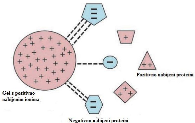
**Slika 13. Shematski prikaz kationsko-izmjenjivačke kromatografije.** Proteini se odjeluju na osnovu svog neto-nabroja. [1]
