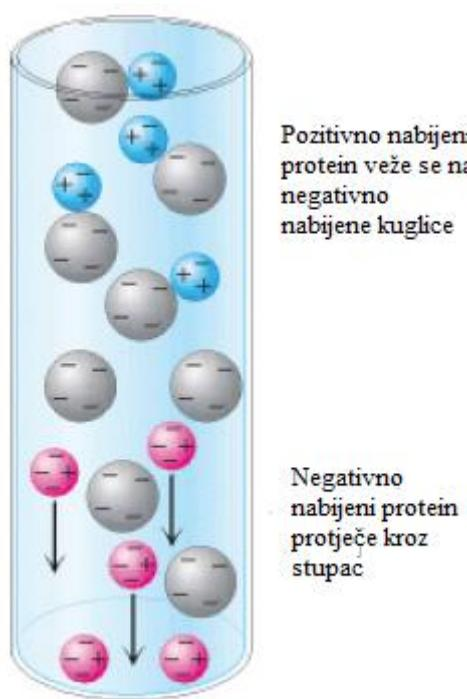
**Slika 14. Anionsko-izmjenjivačka kromatografija.** Proteini se odjeljuju na osnovu svog neto-nabroja.[2]
