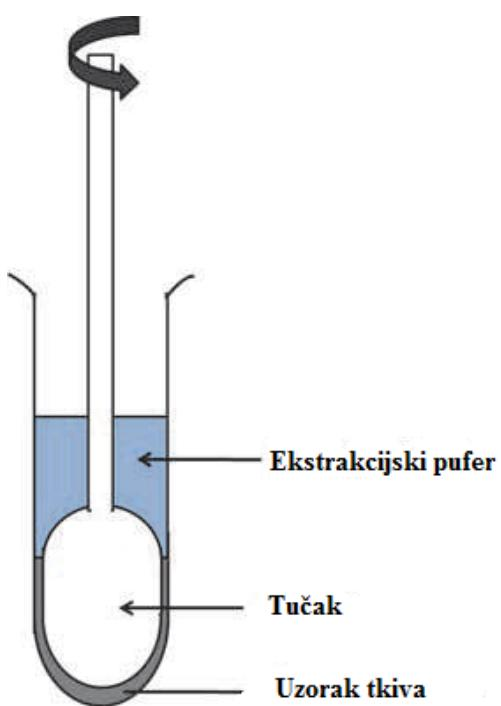
**Slika 2. Ručni homogenizator. [1]**
