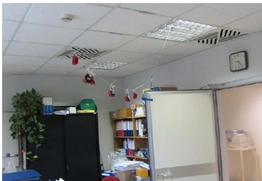
Slika 3.3. Primjer postavljanja uzorkivača u prostoriju
