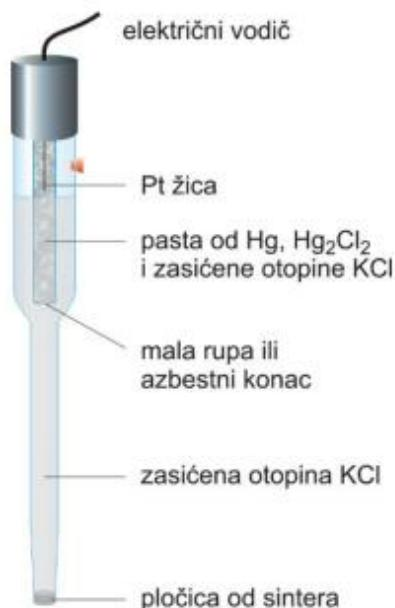
SLIKA 6. Zasićena kalomelova elektroda [12].
