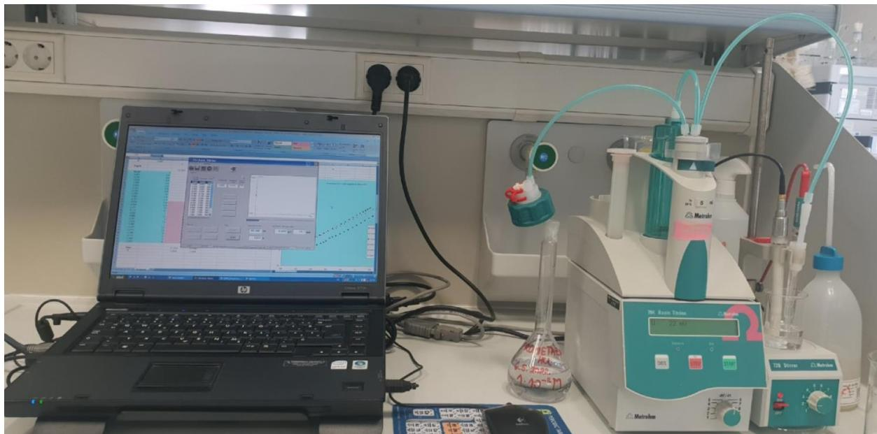
SLIKA 8. Aparatura za direktna potenciometrijska mjerena.
