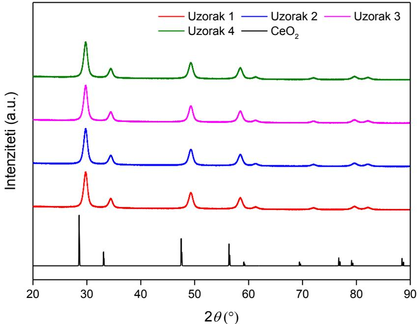
**Slika 1.** Difraktogrami sintetiziranih uzoraka i teorijski difraktogram čistog CeO<sub>2</sub>.
