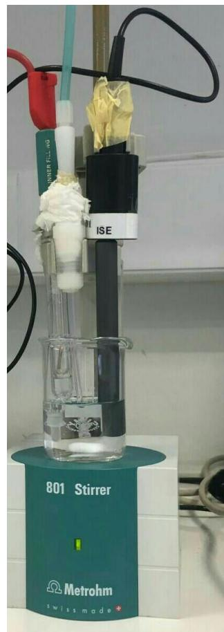
Slika 11. Korišten elektrodnji sustav
