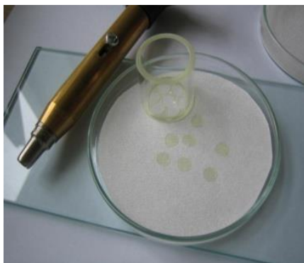
Slika 4. Izrada membrana tenzidno-selektivne elektrode [3]
