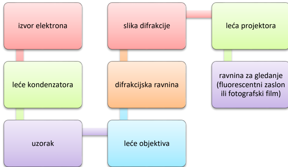
Slika 19. Osnovne komponente transmisijskog elektronskog mikroskopa.
