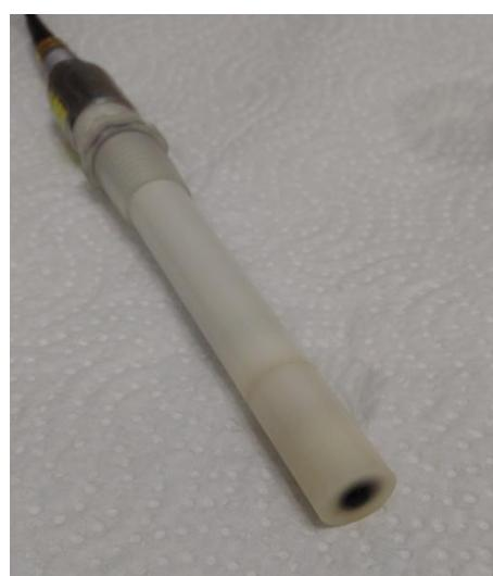
Slika 10. Ionsko selektivna elektroda (MWCNT-TODA-TPB)
