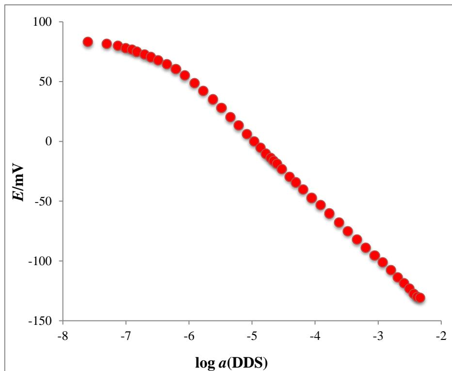
Slika 12. Odzivne karakteristike MWCNT-TODA-TPB elektrode za NaDDS u  $\text{Na}_2\text{SO}_4$
