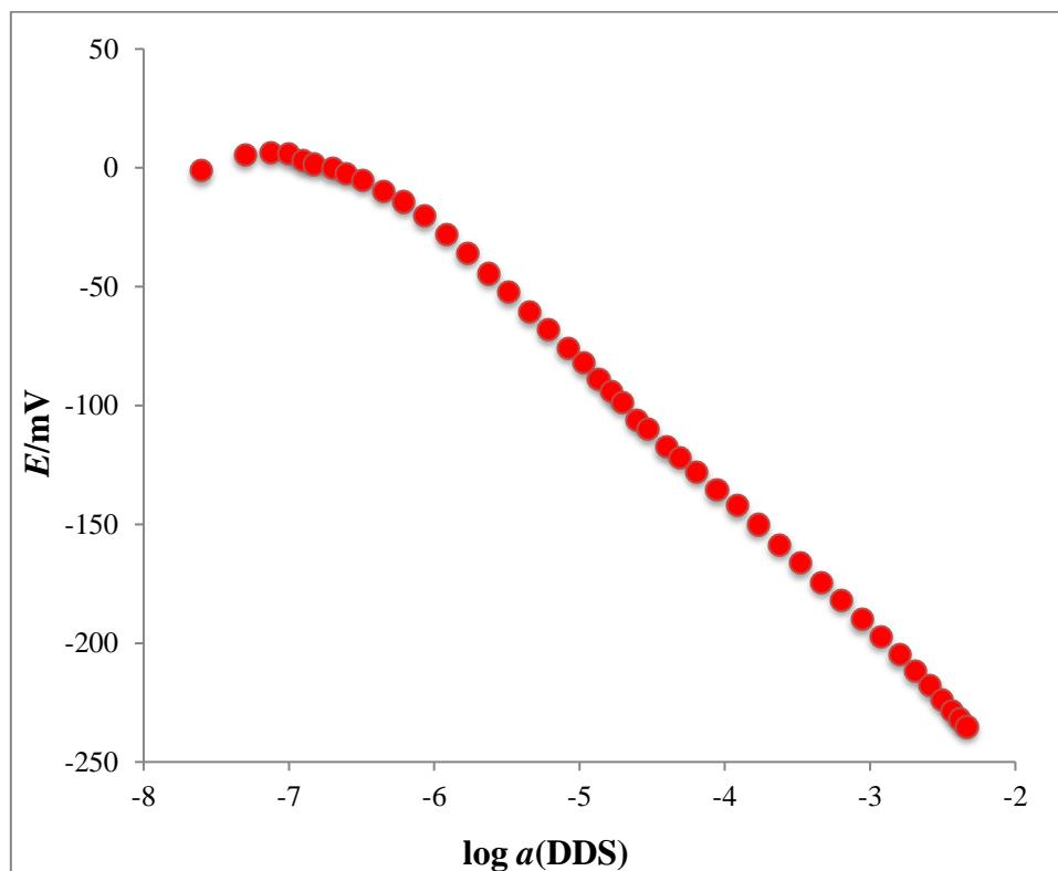
Slika 11. Odzivne karakteristike MWCNT-TODA-TPB elektrode za NaDDS u vodi
