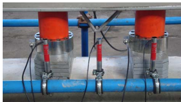
Slika 7. Mjerenje pomaka grede pri unosu opterećenja
