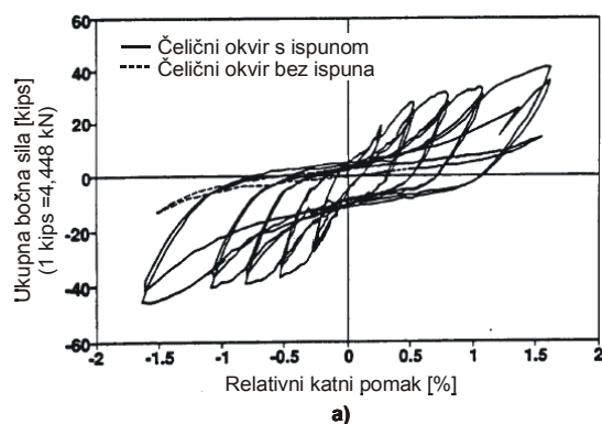
Slika 4. a) Rezultati cikličkog ispitivanja čeličnog okvira sa zidanim ispunom i bez njega prema [13], b) Anvelopa nosivosti zidanog ispuna
