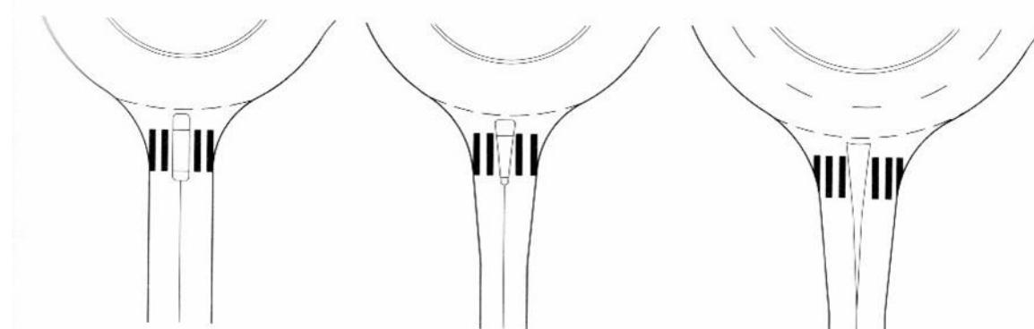
**Slika 8 – Oblici razdjelnih otoka, ovisno o veličini ( $D_v$ ) i brzini uvoženja ( $V_k$ ) a) paralelni b) trokutasti i c) ljevkasti**
