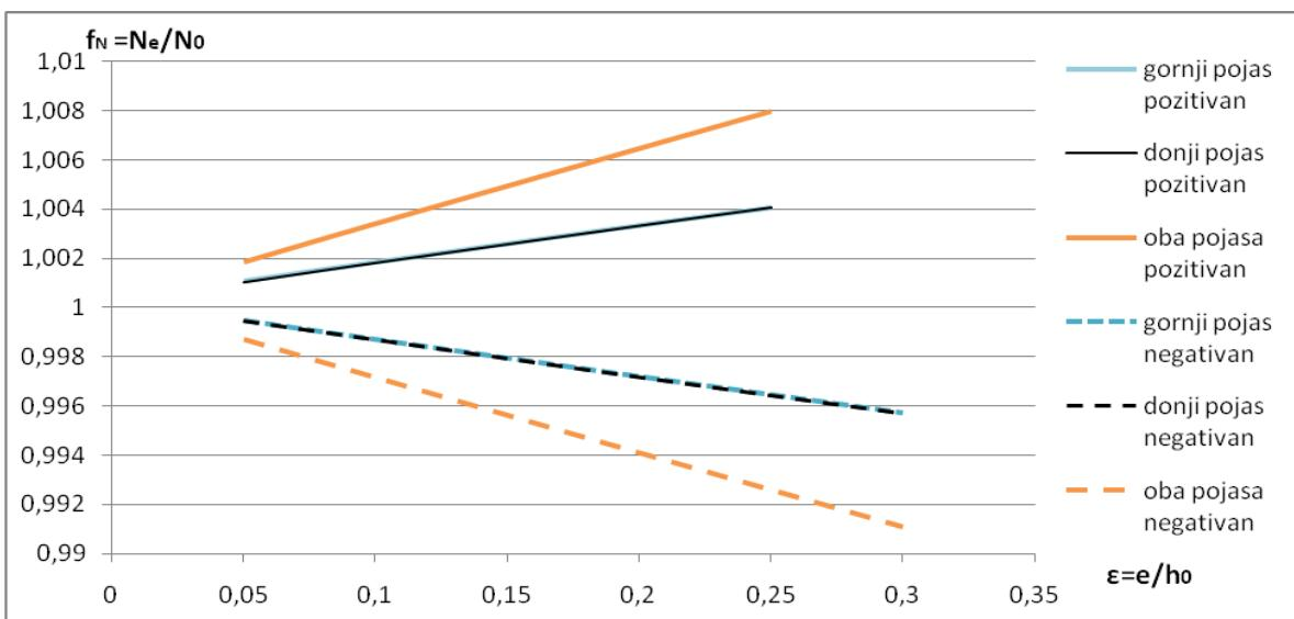
Slika 6 – Rezultati proračuna VLAČNE ispune dobiveni pomoću SAP2000 14 [2]
