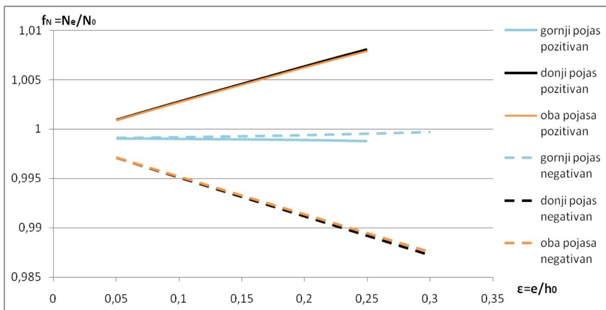
Slika 5 – Rezultati proračuna TLAČNE ispune dobiveni pomoću SAP2000 14 [2]
