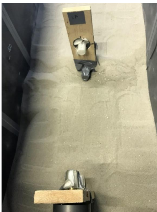
Slika 40. Benderovi elementi postavljeni u spremniku s pijeskom.
