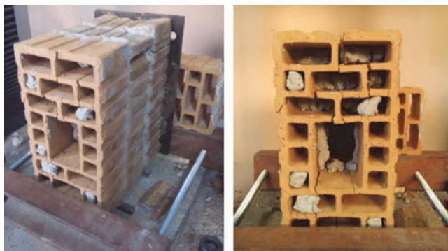
Slika 6. Vlačni lom zidnog elementa pri posmiku kao posljedica prodiranja morta u šupljine
